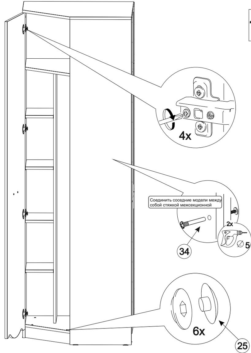
Соединить соседние модели между собой стяжкой межсекционной
