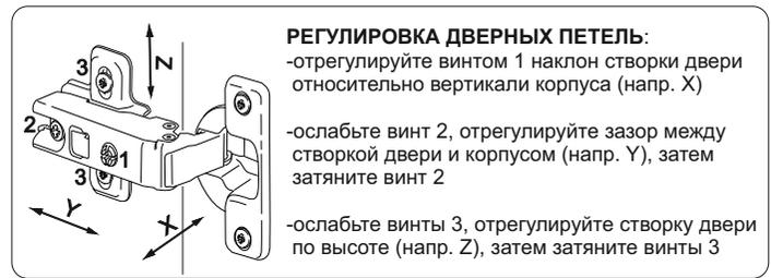
**РЕГУЛИРОВКА ДВЕРНЫХ ПЕТЕЛЬ:**
